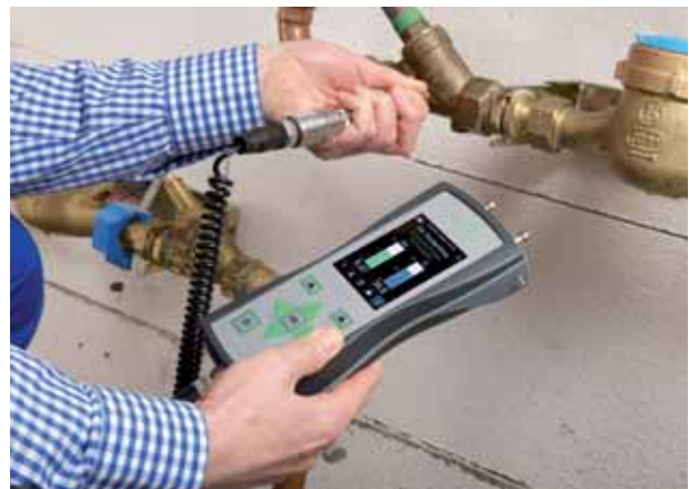
Einsatz mit Hochdrucksensor bis 25bar
