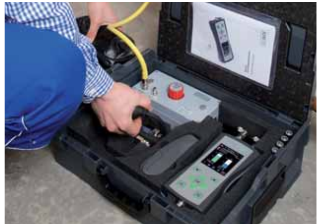
Leckmengenmessung mit Zähler mit externer Gasversorgung GV-100
